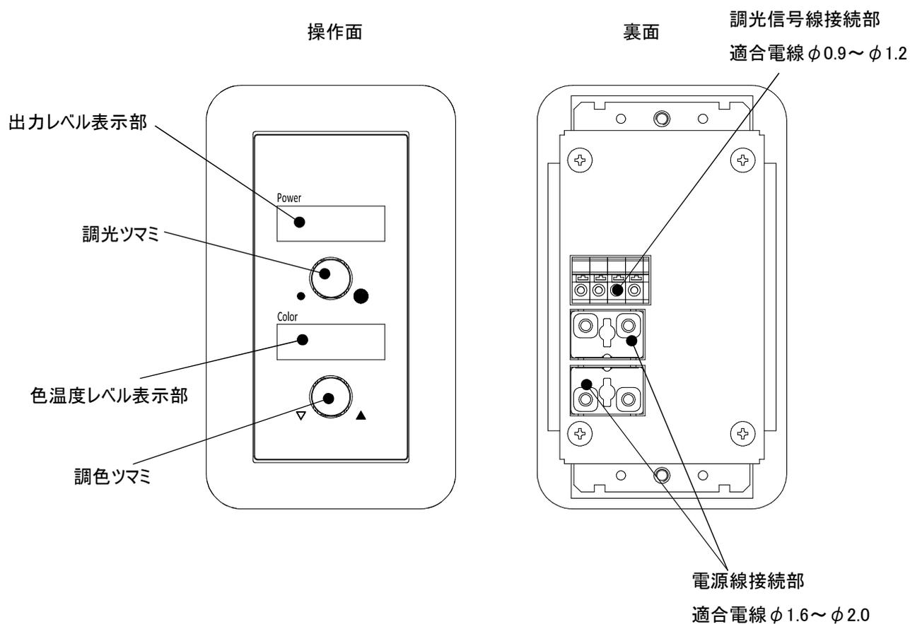
調光ツマミを時計回転方向に回すと照明光の明るさが増します。
